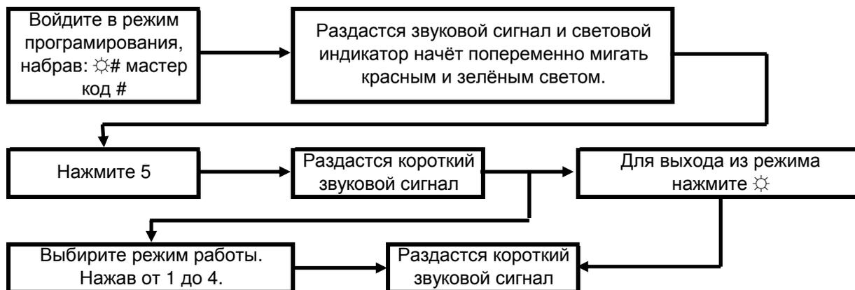
**6. Режим включения микропереключателя (тампера) :** Данный режим используется, если вы хотите защитить данное устройство от несанкционированного снятия или при попытке проникновения в помещение через дверь.
