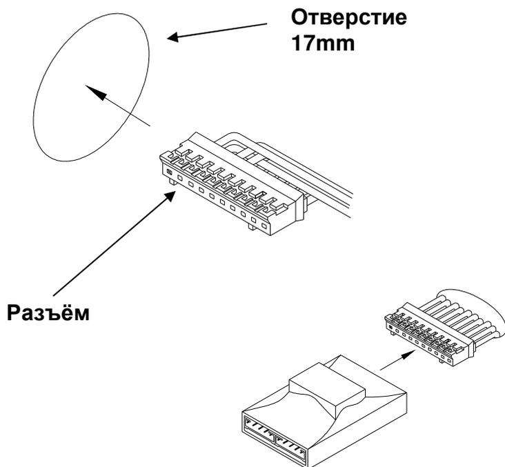
**Протянув через просверленное отверстие кабель с разъёмом подключите к нему внешнему реле.**
